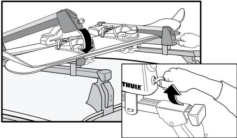
**S** Observera att Skidbindingarna inte kommer för nära taket. Transportera alltid skidorna med spetsarna bakåt. Lås alltid under transport.
