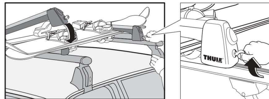
**S** Observera att Skidbindingarna inte kommer för nära taket. Transportera alltid skidorna med spetsarna bakåt. Lås alltid under transport.
